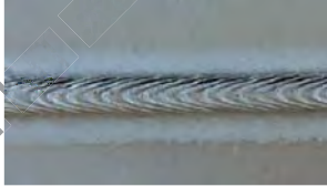
1.0mm AlMg3板 角焊, 焊接速度2.0m/min
