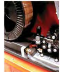
图3 四轮送丝机使用石墨纤维
