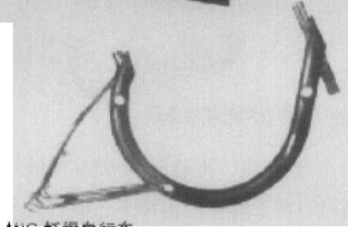
图6 机器人MIG钎焊自行车
