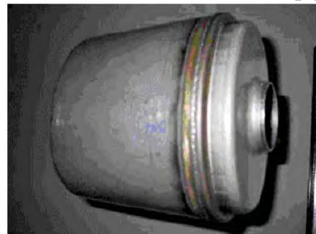
重型汽车排气系统, Tandem 双丝MIG钎焊AIBZ8, 焊接速度 6m /min
