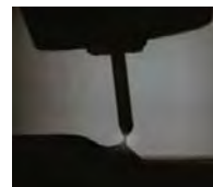
焊丝回抽，帮助熔滴脱落
