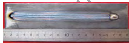
焊缝表面成形
