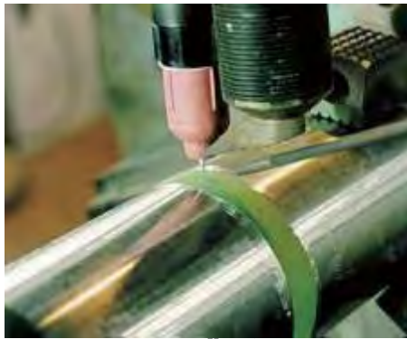
1G, 管道焊接
