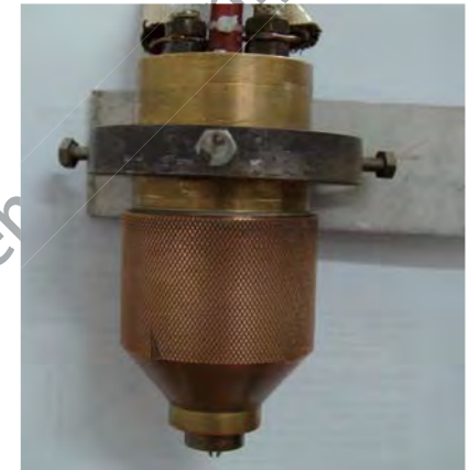
双钨极氩弧焊枪实物
