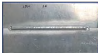
平板对焊试件 (有收弧, 板材LD10)
