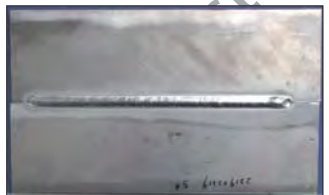
平板对焊试件 (有收弧, 板材2219)
