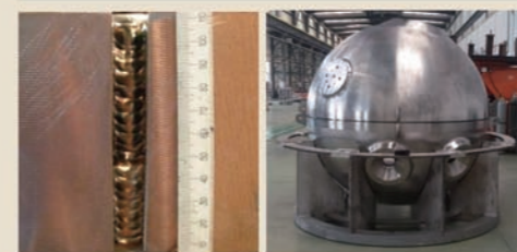
4500米深潜器耐压壳体窄间隙焊接
