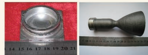
C/SiC复合材料-Nb的连接
