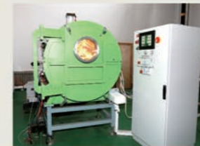
空间焊接地面模拟试验装置
