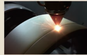
超高速激光熔覆 (20-200m/min)
