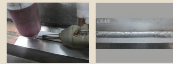
铝/不锈钢热丝TIG熔钎焊 焊缝成形
