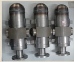
贮气罐产品不预热复合焊接焊缝
