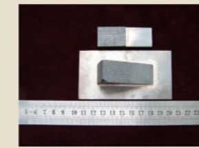
C/C复合材料-TiC4的钎焊
