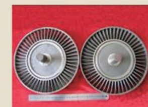
耐热合金-耐热钢扩散焊
