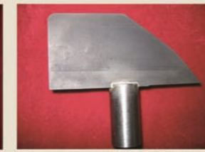
Cu基TiB 2 金属陶瓷-TiAl
