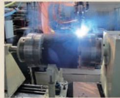
中厚壁高强度机器人激光电弧复合焊接
