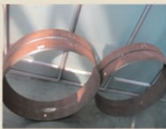
X70钢管道焊缝成型及其横截面
