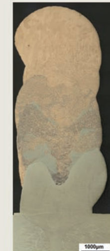
铜/钢梯度复合材料 Copper-steel composite material
